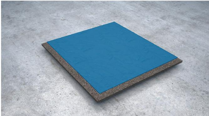
Lámina de caucho reciclado (EVA) laminado con un plástico LDPE que actúa como barrera de vapor. Sus propiedades mecánicas ofrecen un excelente aislamiento acústico al ruido de impacto y una barrera de vapor anti humedad.
