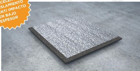
Lámina de caucho reciclado (EVA) laminado con una lámina de aluminio puro que actúa como barrera de vapor y disipador de carga electrostática. Sus propiedades mecánicas ofrecen un excelente aislamiento acústico al ruido de impacto, además de una barrera de vapor anti humedad y propiedades térmicas. Air-bur Sound Silver es apto para calefacción radiante.
